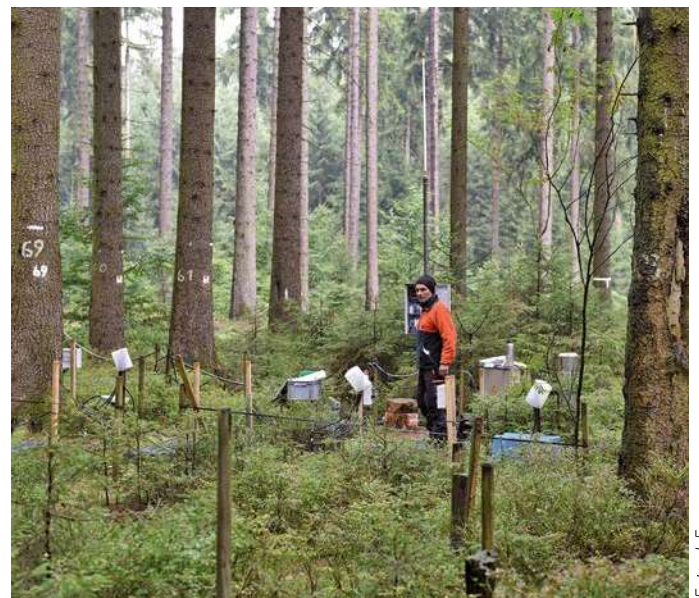
Bodenhydrologisches Messfeld auf einer Level II-Fläche
