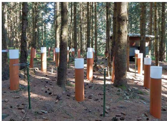
Erfassung des Bestandesniederschlages auf einer Intensiv-Monitoringfläche
